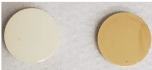
Fig. 1. 気相2abIm処理前後のLIPS法で得たZIF-8膜 (左: 処理前, 右: 処理後)
